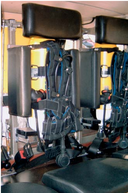
Das Atemschutzgerät muss in der Halterung gesichert bleiben.
