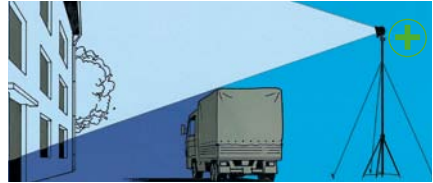
Hoch angeordnete Lichtquellen verringern die Schattenbildung.
