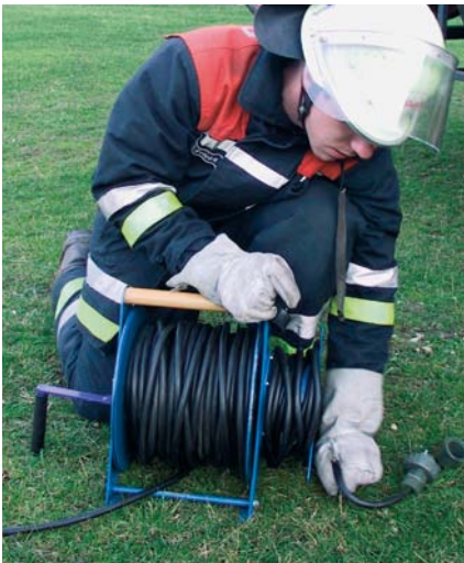
Leitungstrommeln bei der Benutzung ganz abwickeln.
