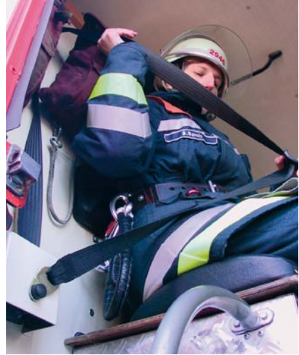
Nachgerüsteter Sicherheitsgurt mit Aufrollautomatik im Mannschaftsraum
