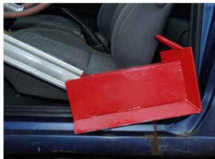
Einsatz eines Rettungszyinders mit Schweller- aufsatz.
