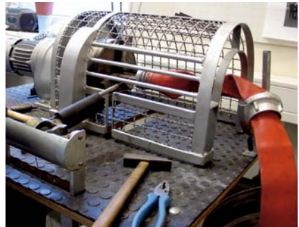
... mit wirksamer Schutzeinrichtung gegen sich lösende Teile
