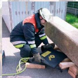
Hebekissen weit einschieben – mind. 75 % unter die Last
