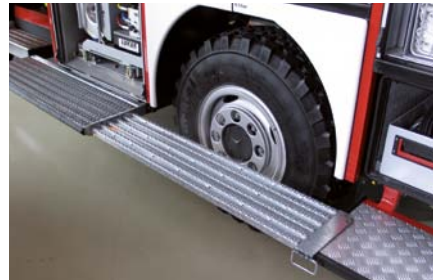
Sichere Geräte-Entnahme. Durch den Auszug lässt sich die Lücke schließen und ein sicherer Auftritt auch über die ganze Aufbauhöhe herstellen.
