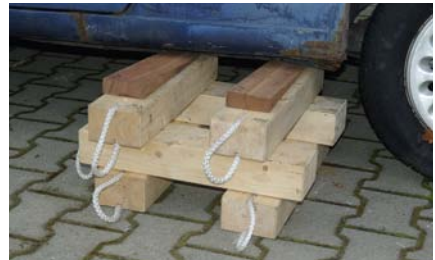
Unterbau durch Rüsthölzer
