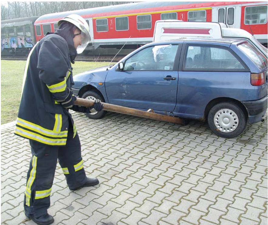
Schnelle Lastbewegung mittels Hebebaum
