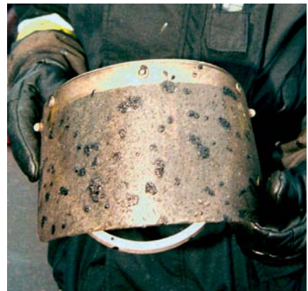
Gesichtsschutz nach starker Wärme-Einwirkung
