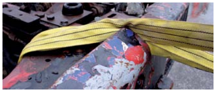
Vorsicht! Hebebänder nicht über scharfe Kanten spannen.
