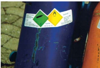
Gefahrzettel an einer Sauerstoffflasche (Transportgefäß)
