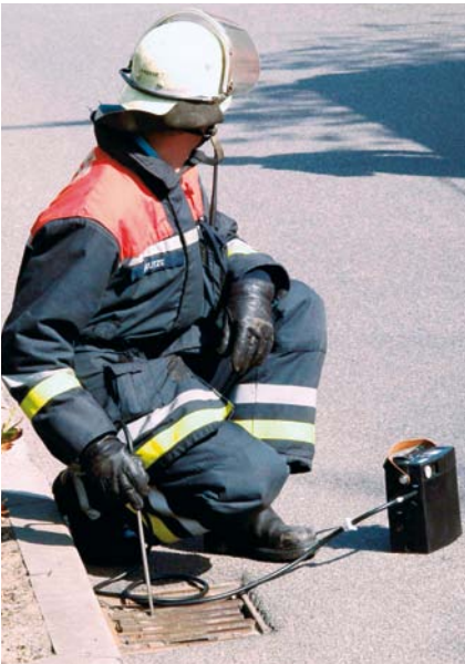
Messgeräte-Einsatz zur Feststellung von Explosionsgefahren
