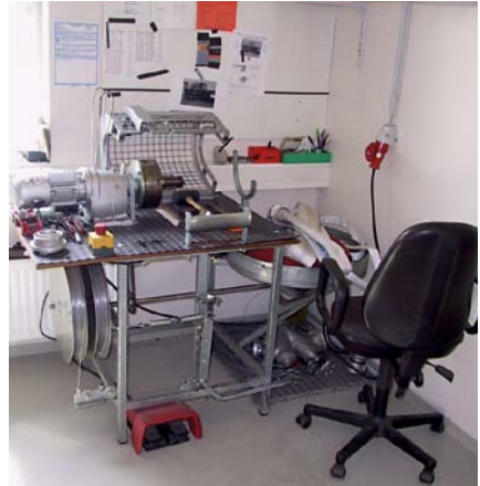
Arbeitsplatz zum Einbinden von Schlauchkupplungen ...
