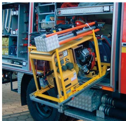
Schräglagerung des Geräteschlittens
