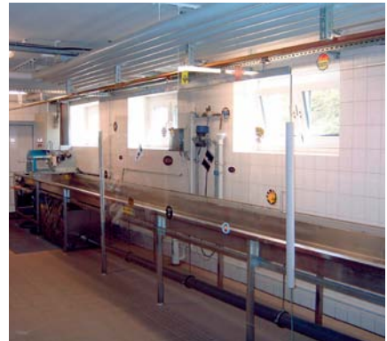
Abschirmung gegen Nässe und den Wasserstrahl platzender Schläuche
